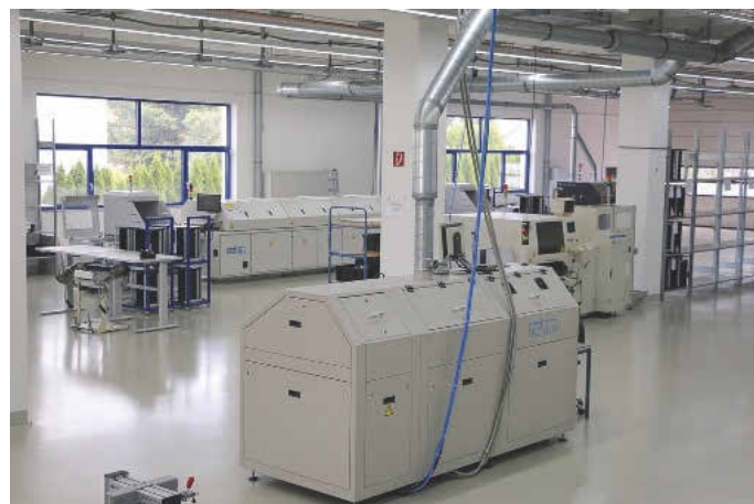
Gelötet wird auf den 1.000 m 2 SMD-Produktion mit Lötanlagen von Rehm.
