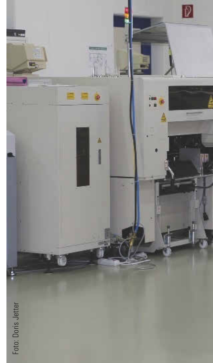
Die 4 SMD-Linien sind mit Bestücksystemen von Juki ausgestattet.
