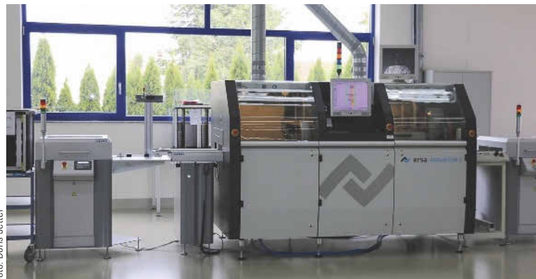
Gelötet wird unter anderem mit der bleifreien Selektivlötanlage Versaflow von Ersä.
