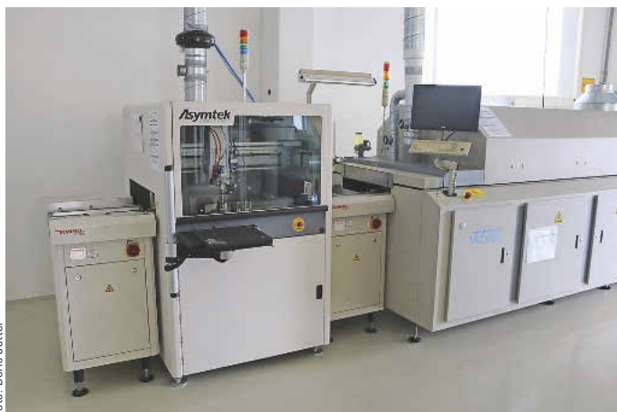
Inline Lackier- und Beschichtungsanlage von Asymtek.
